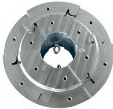
Kernunterseite nach der Fräsbearbeitung
