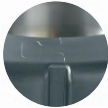
Detailaufnahme Formkontur am zusammengebauten Kern
